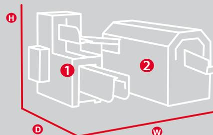
Incassatrice X-Case Plus in linea con doppia pressa oleodinamica e formatrice di canaletto a caldo VIP Forming.
