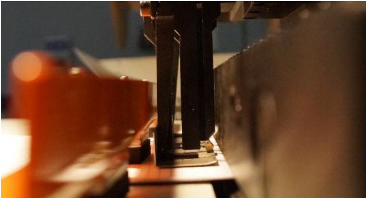
Рис. 9. Положение полчки ригеля относительно изделия. Полочка почти лежит, но не касается изделия. На рисунке отчетливо виден минимальный зазор между устройством и планкой.
