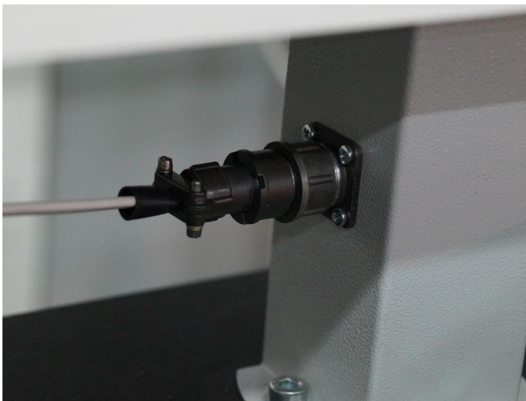
Рис. 1 . Разъем подключения устройства вставки ригеля (находится на правой стойке столешницы).
